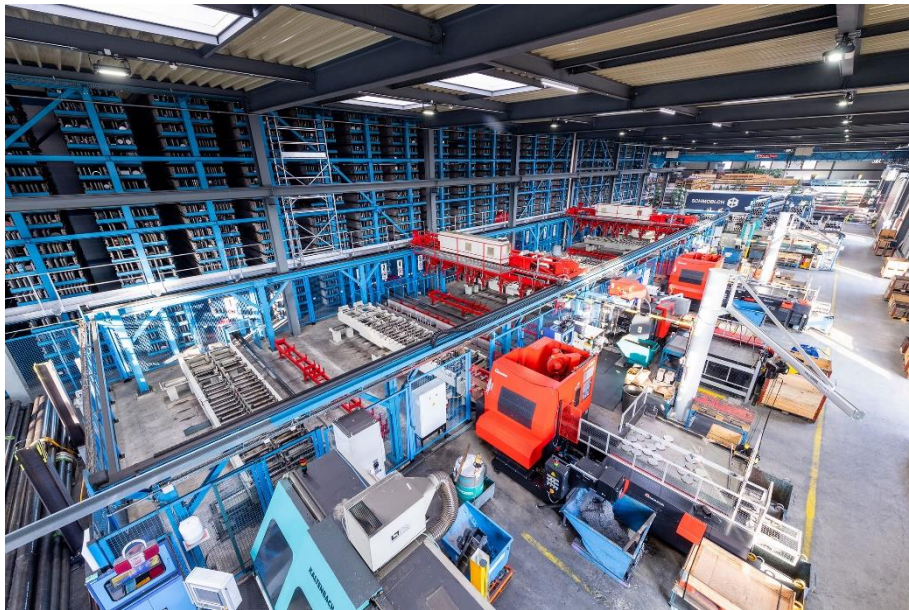
Abbildung 1 Vollautomatisches Sägecenter (Bild SCHMOLZ + BICKENBACH Stahlcenter AG)
